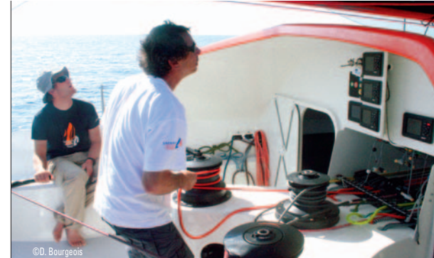
Le meuble central en "Y" permet de dispatcher les manœuvres sur l'un des trois winches à la sortie de la goulotte, réglés à la manivelle ou par la colonne de moulin à café.
