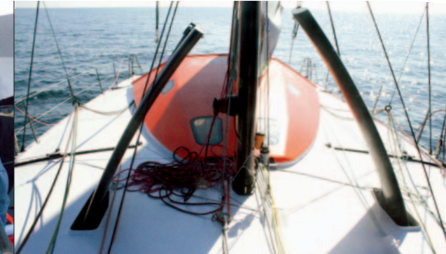
Originales les dérives courbes inspirées par les foils des trimarans Orma : l'objet est avant tout de réduire l'encombrement et de faciliter la manipulation.
