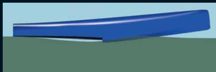
La coque après la phase de déjaugage. La poche d'air se formant derrière le redan est ici bien en évidence.
